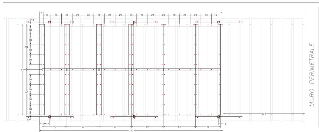
PARTICOLARE STRUTTURA SOSTEGNO LASTRA CL.1 EI30,
