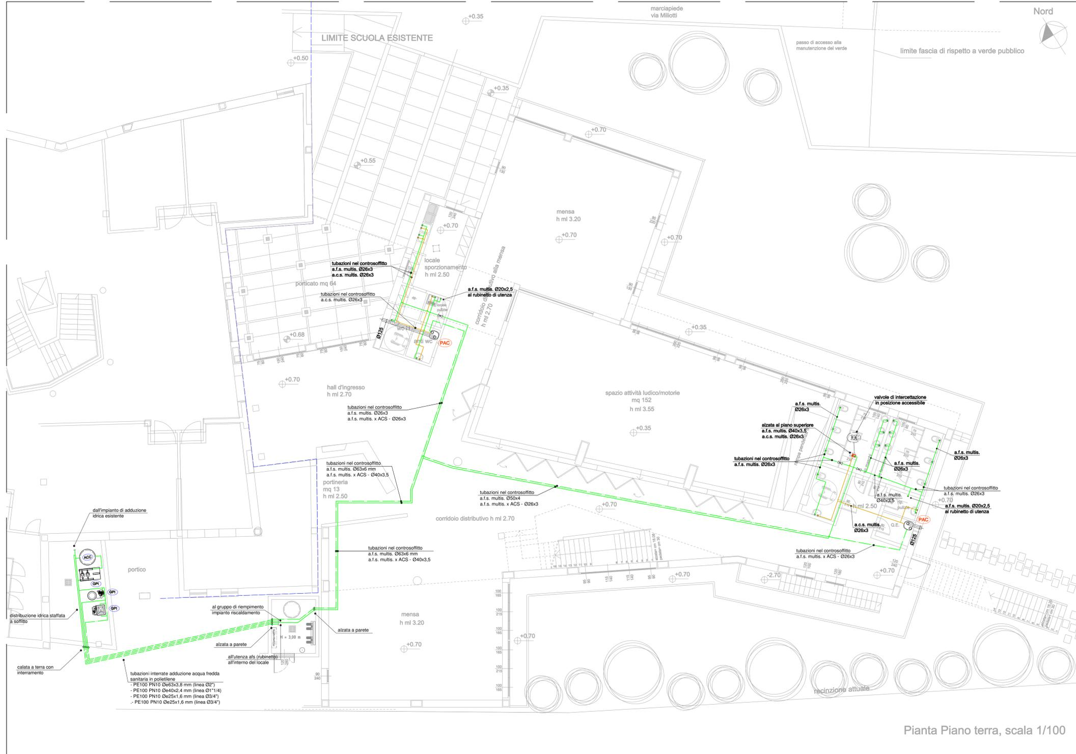
N.B.2 - LO STAFFAGGIO DELLE TUBAZIONI DI CIASCUNA TIPOLOGIA DI IMPIANTO PREVISTO DOVRA' ESSERE RISPONDENTE ALLA NORMATIVA ANTISISMICA E REALIZZATA A REGOLA D'ARTE, MEDIANTE L'IMPIEGO DI COMPONENTI MECCANICI IDONEI ALLA COMPENSAZIONE DELLE DILATAZIONI TERMICHE (PUNTI FISSI E SCORREVOLI)
