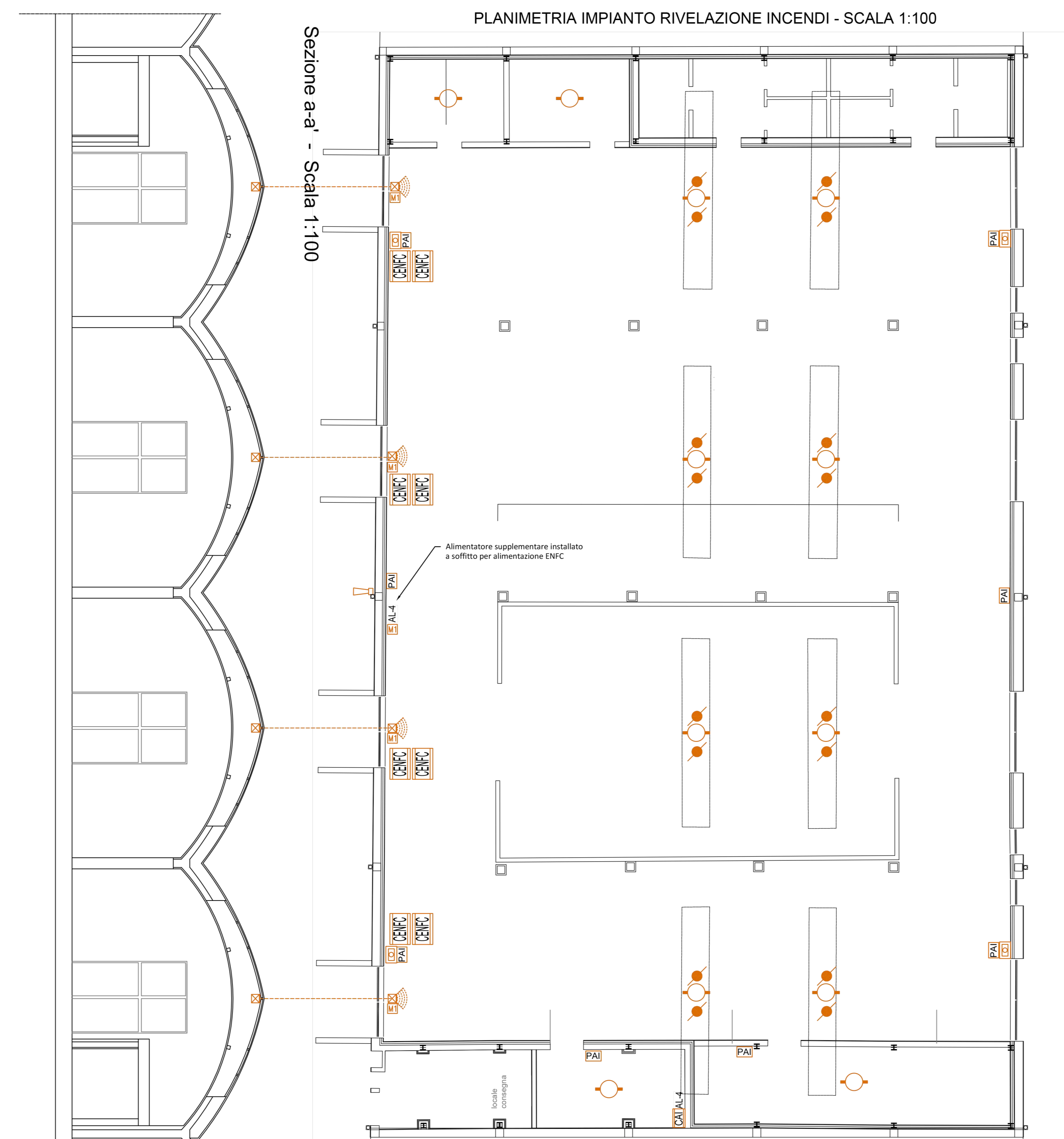
PLANIMETRIA IMPIANTO RIVELAZIONE INCENDI - SCALA 1:100
