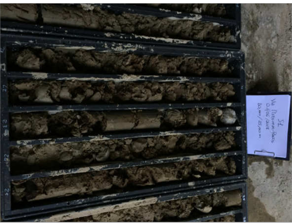
Sondaggio S1: da -20,00 a -25,00 m da p.c.
