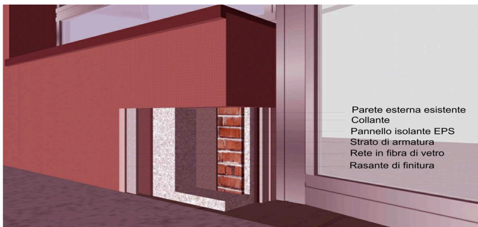
SIMULAZIONE RENDERING - COIBENTAZIONE A " CAPPOTTO EPS " -
