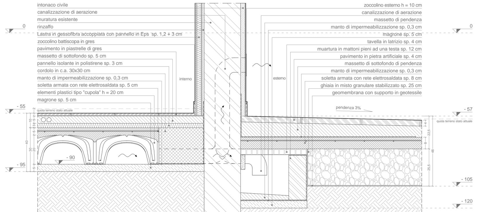
dettaglio 02 - solaio tipo piano terra
