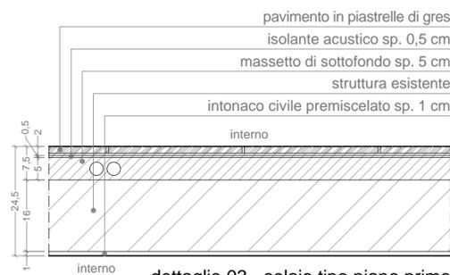
dettaglio 03 - solaio tipo piano primo
