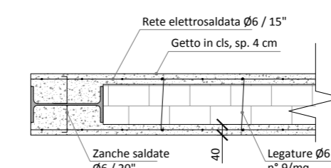
PARTICOLARE GENERICO ESECUZIONE BETONCINO scala 1:10
