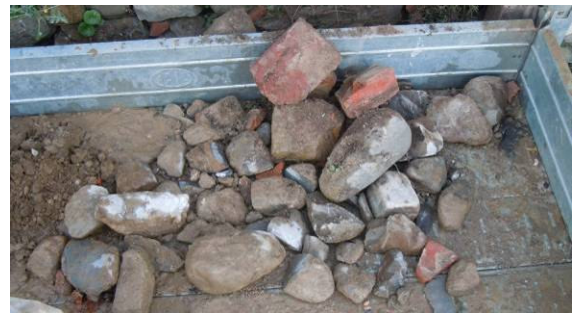
Materiale estratto dal carotaggio
