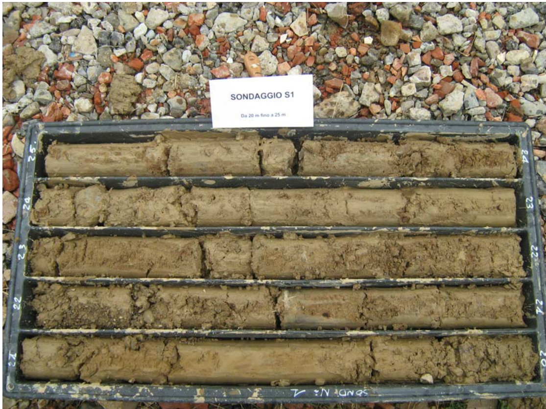
Foto 10 – Foto sondaggio da 20,0 m a 25,0 m.
