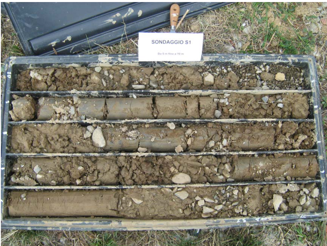
Foto 6 e 7 – Foto sondaggio da 0,0 m a 5,0 m e da 5,0 m a 10,0 m.
