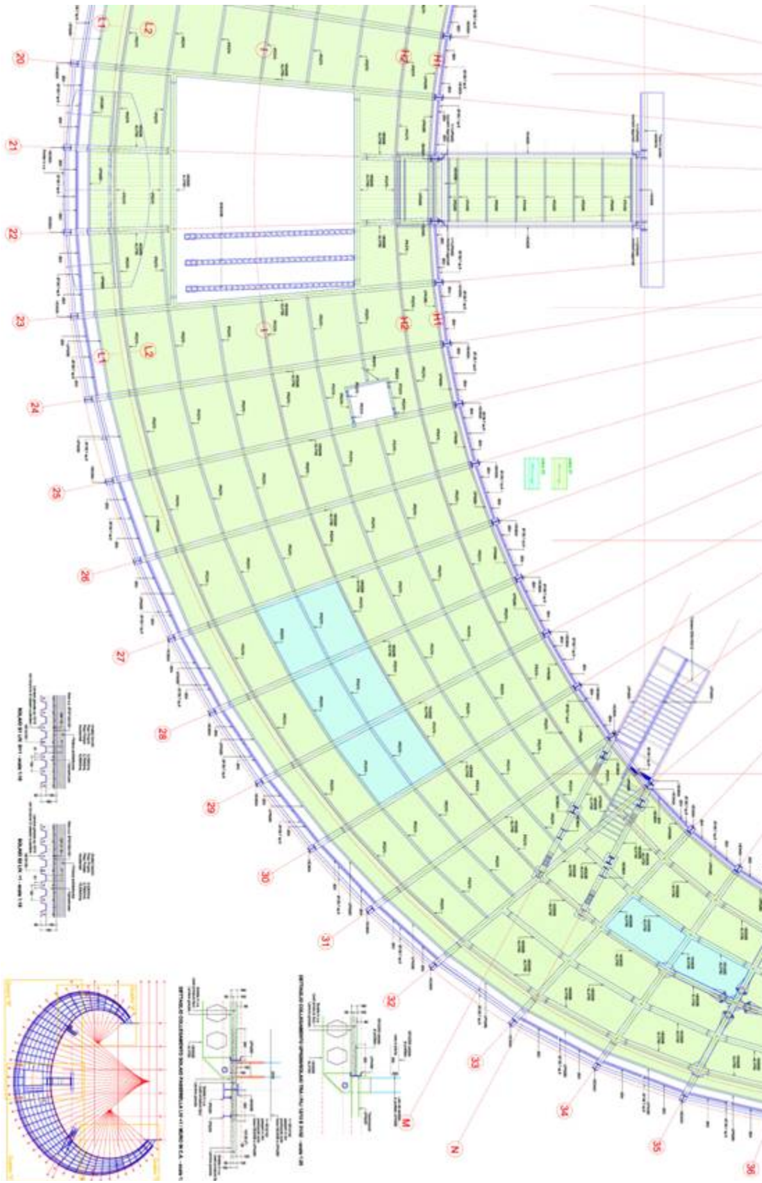
Rappresentazione della aree con diverso sovraccarico (verde 6.00 kN/m 2 celeste 10.0 kN/m 2 )
