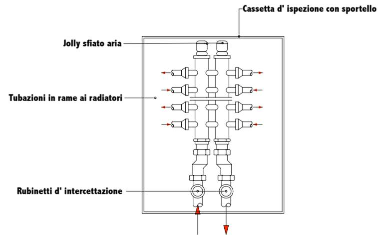
**Dettaglio installazione collettore**
