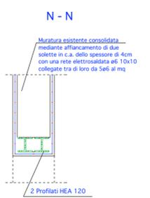
Aperture da realizzare nei Muri esterni consolidati mediante affiancamento di una o due solette in c.a. dello spessore di 4cm con rete elettrosaldata ø6 10x10
